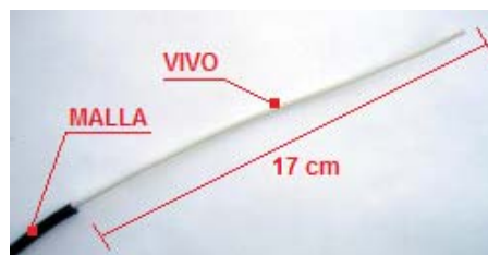
IMG-2. CREACIÓN DE UNA ANTENA EXTERIOR A PARTIR DE UNA CABLE DE 50 OHMIOS
