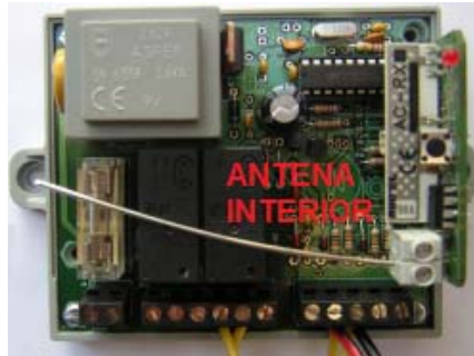
IMG-1. CONEXIONADO ANTENA INTERIOR
